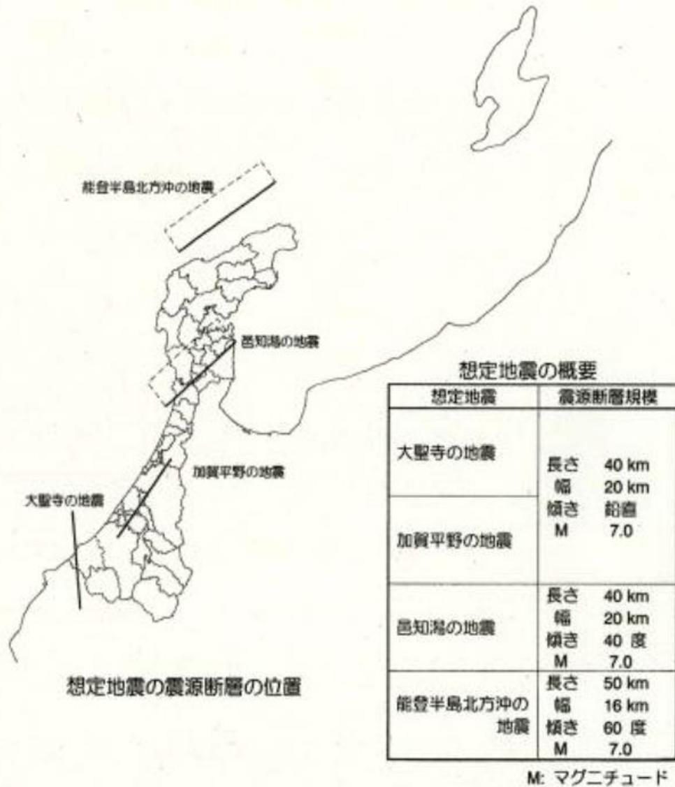
断層面が地表に対して垂直な場合（大聖寺の地震・加賀平野の地震）では、断層の位置は線上になっている。
