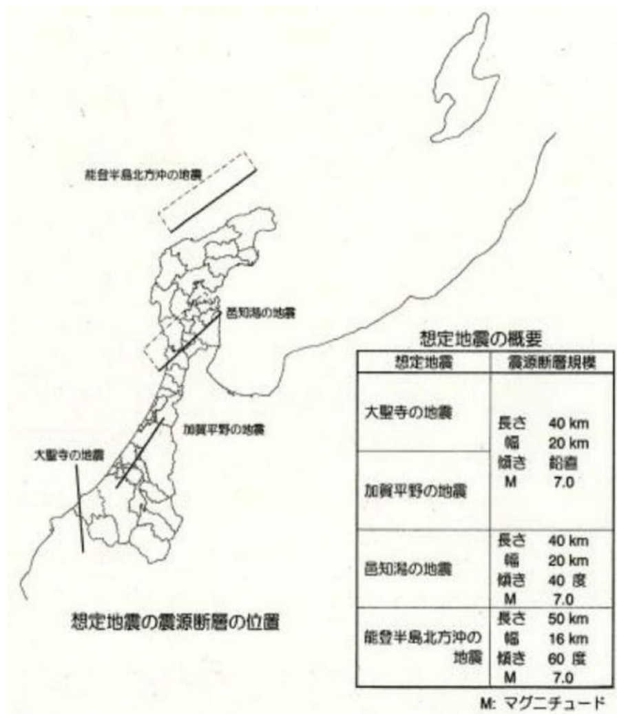
図 2.1-2 前回の地震被害想定における想定震源：4 ケース
