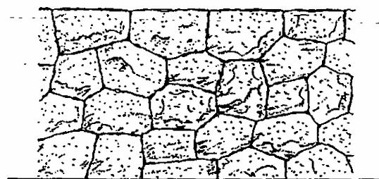
(2) 請負者は、天端石のある場合は、天端石に天端以外の部分に使用する石よりも大きい石材をできるだけ使用し、稜線が通るように施工しなければならない。
