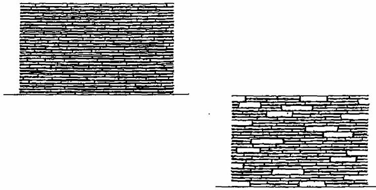
(2) 請負者は、天端石のある場合は、天端石に大きい石材を使用し、稜線が通るように施工しなければならない。
