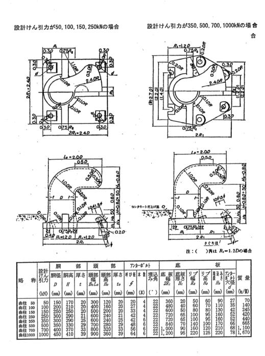
図 4-2 曲柱の標準寸法と設計けん引力
