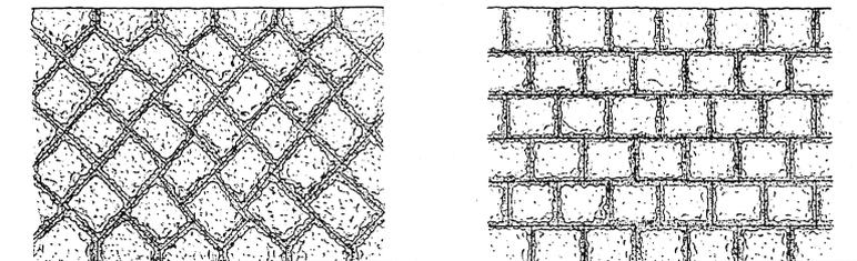
14. <sup>わりいしづみ</sup>割石積の施工については、以下の各号の規定による。
