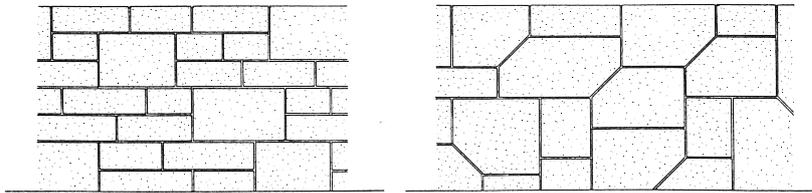
13. <sup>けん ちいしづみ</sup>間知石積、<sup>ざつわりいしづみ</sup>雑割石積、<sup>ざいしづみ</sup>雑石積の施工については、以下の各号の規定による。
