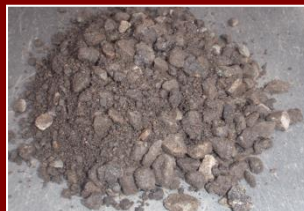
【破碎施設】 破碎処理⇒再生骨材の製造
