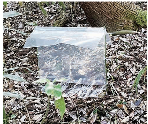
写真10 衝突板トラップ (幅450mm、高さ300mm)
