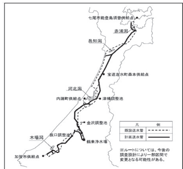
図11 県営水道の送水管耐震化事業
