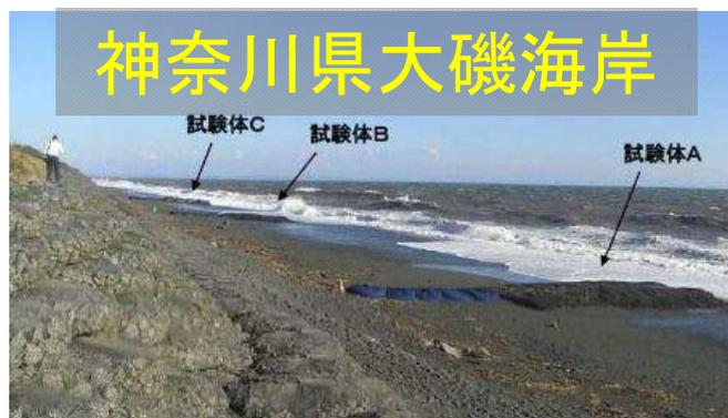
岩盤を模した新たな漂砂制御施設の試験体として供試体A(座布団型)、供試体B(3連型)、供試体C(直方体連結型)の耐久性を確認(設置期間中の破損無し)
