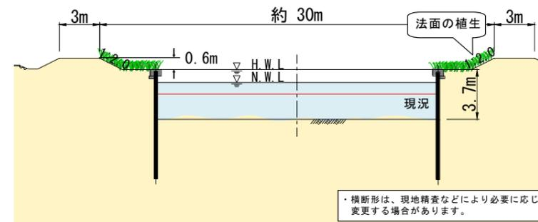
図 6 弓取川河口から 0.7km 付近の横断面図
