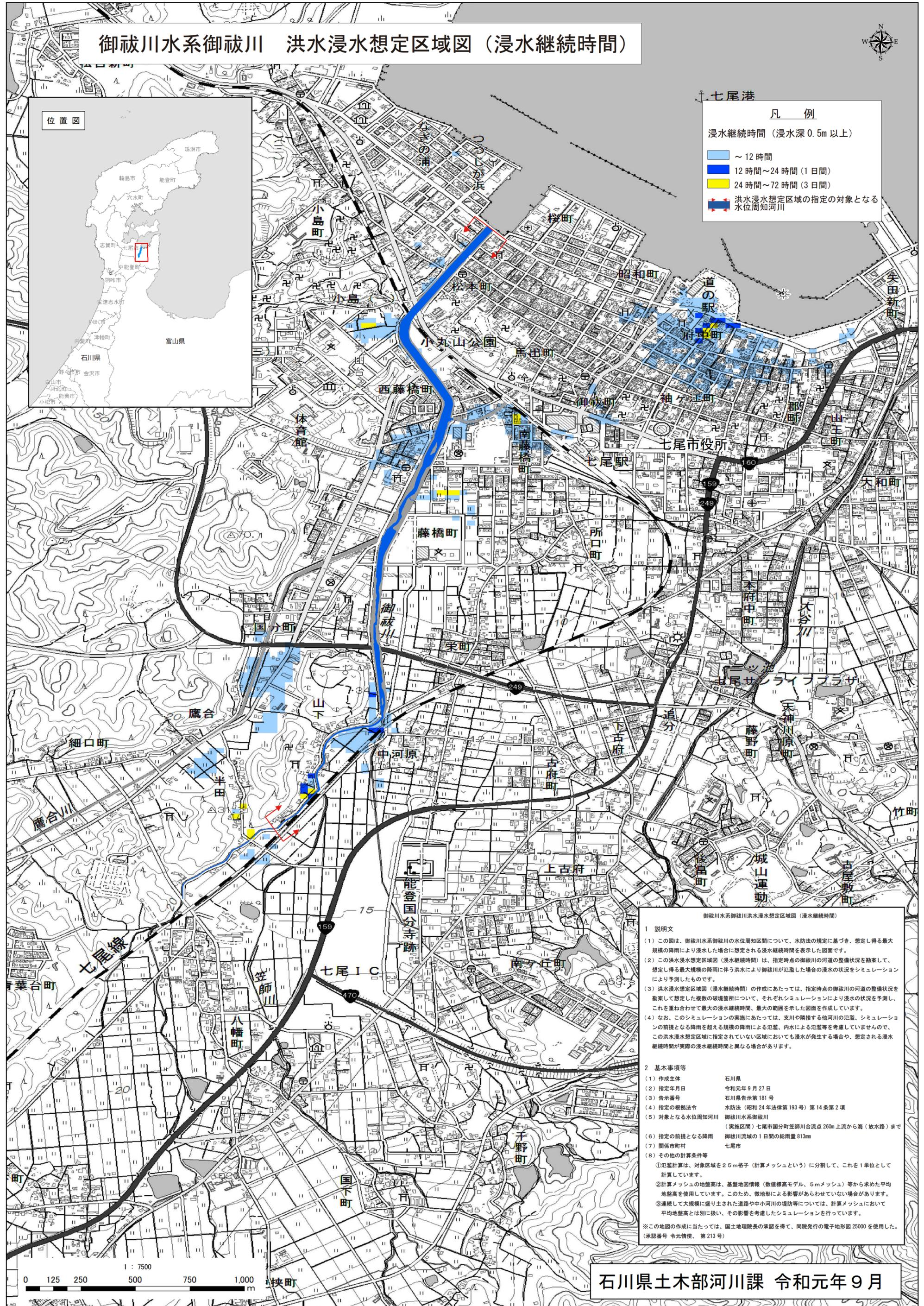
御祓川水系御祓川洪水浸水想定区域図（浸水継続時間）
