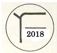
修理済表示 (補修又は取替)
