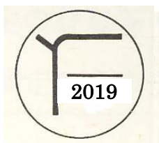
修理済表示 (補修又は取替)
