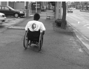
横断勾配で流される車いす
