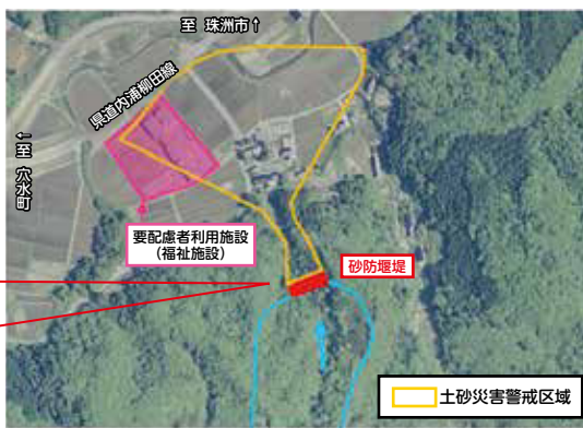
砂防堰堤により要配慮者利用施設を保全（能登町五郎左エ門分）
