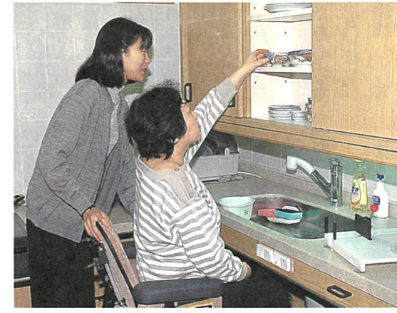
キッチン、グリル、頭上の収納棚が上下に動きます
