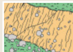
小石がぼろぼろ落下し、亀裂が走る
