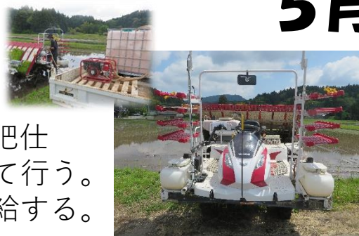
図 田植え機（例） ヤンマーYR8D 左上：ペースト肥料 補給の様子
