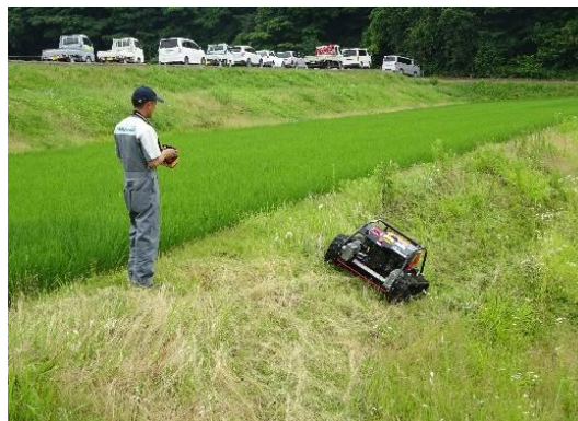
図2：リモコン草刈機による除草作業
