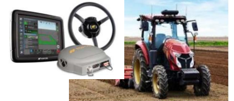
トラクターの自動操舵装置による自動走行
