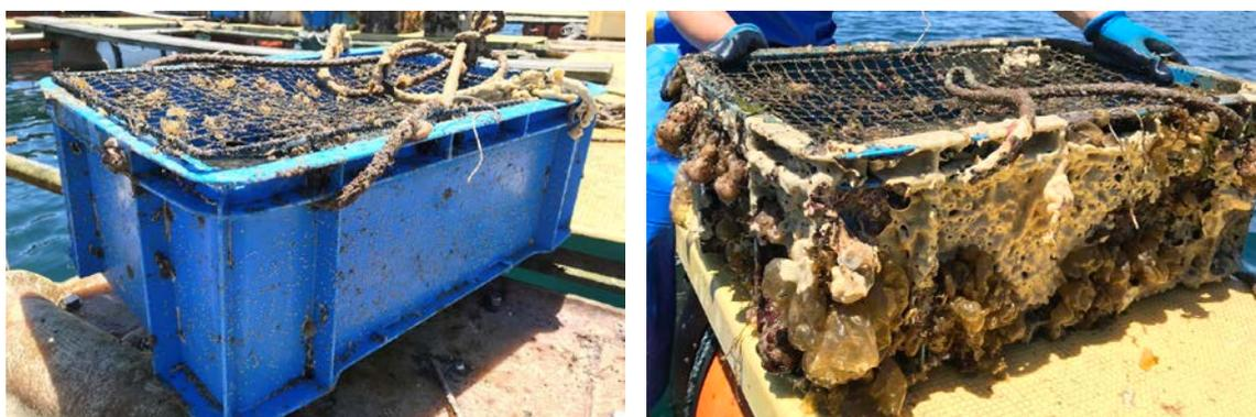
図 試験開始10か月後のシリコン塗料区(左)と対照区(右)の比較
