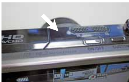
図-10. GPSカメラのアンテナ位置の例 このように、外見からはまったくわからない場合もある。
