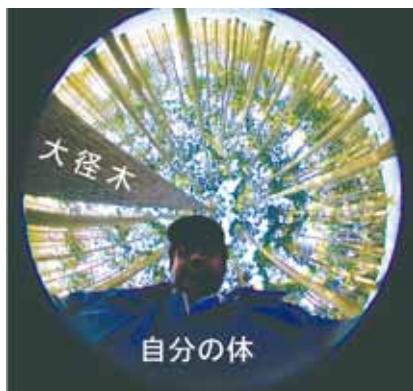
図－5. 受信機の位置からの全天写真 大径木がすぐ近くにある場合や受信機を胸の前に構えた場合、電波が遮断・反射されやすくなる。
