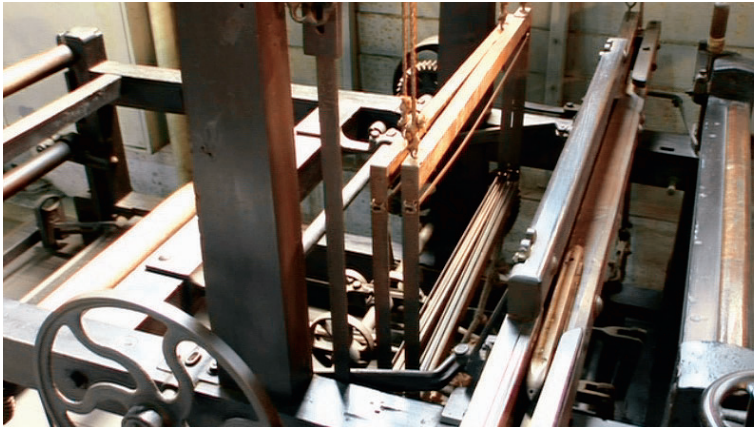
津田式羽二重織機の実機（博物館明治村）。津田米次郎が発明し、東京の松尾工場で製品化される
