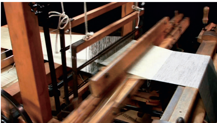
津田式力織機（復元／日本工業大学 工業技術博物館）。明治村の実機、石川県立歴史博物館所蔵の当時の設計図をもとに復元された
