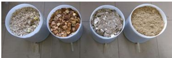
図1-2 脱臭槽の写真 (左から、ロックウール、木質チップ、カキ殻、廃ほだ木)
