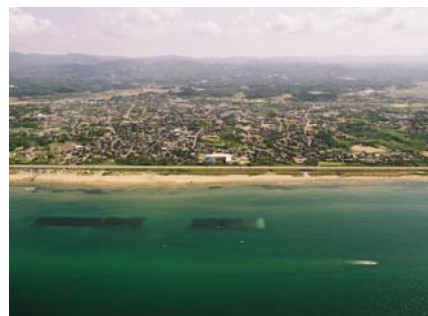
人工リーフを採用することにより、水平線の見通しを阻害しないように配慮 (七塚海岸／かほく市)
