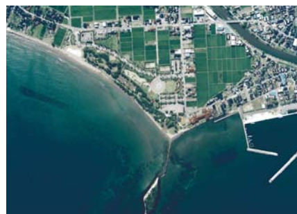
人工リーフの設置により、白砂青松の砂浜が復活し、レジャー拠点として利用 (宝立正院海岸／珠洲市)
