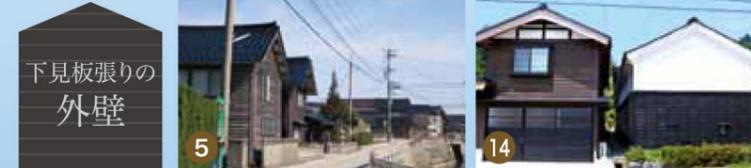
下見板張りは、木製横板の上下がお互い少しずつ重なり合うように取り付けられた外壁仕上げの総称です。雨風の吹き込みを防ぐことに優れており、日本海の強風から家屋を守るために能登の海岸沿いの家屋の外壁として多用されています。
