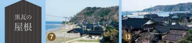
黒瓦（能登瓦）は、瓦の表面と裏面の両面に釉薬が施されており、防水性、耐塩害性において高い性能を有しています。また、高温焼成により長年にわたって光沢感が失われないという特徴も持っています。
