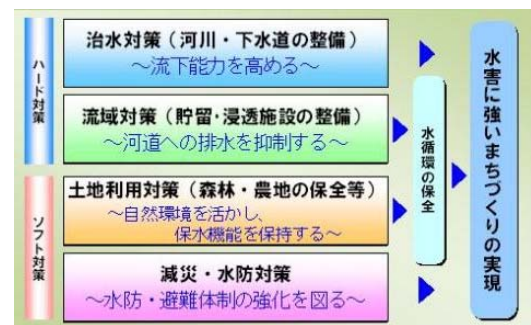
ハード・ソフトによる総合治水対策 (金沢市総合治水対策<金沢市>)
